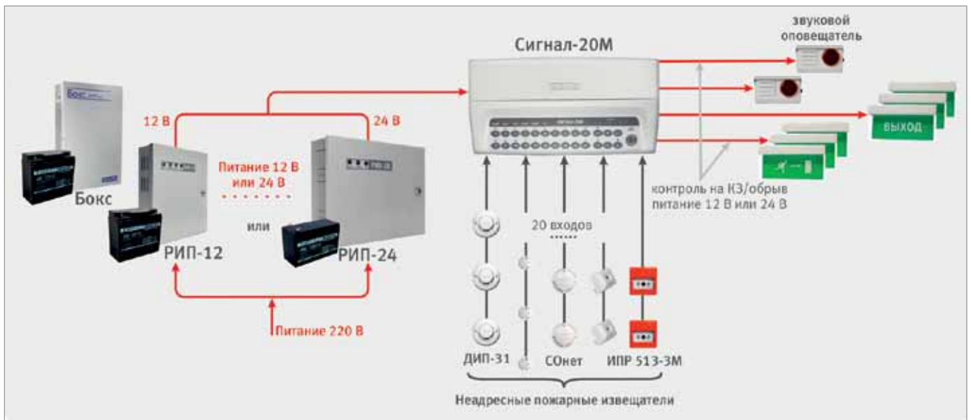
Рис. 1. СОУЭ 1-го и 2-го типа на базе ППКУП «Сигнал-20М»
