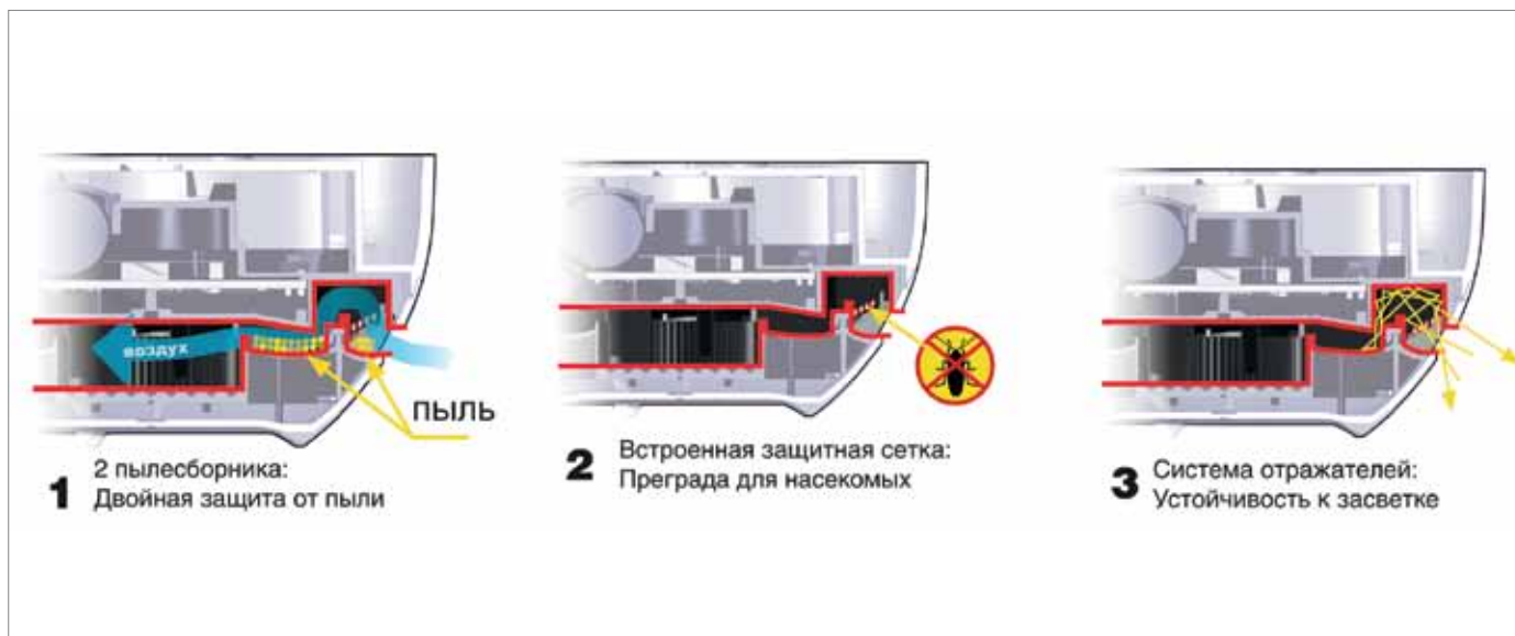
Рис. 3. Уникальная конструкция извещателей серии «Аврора-ПРО»
