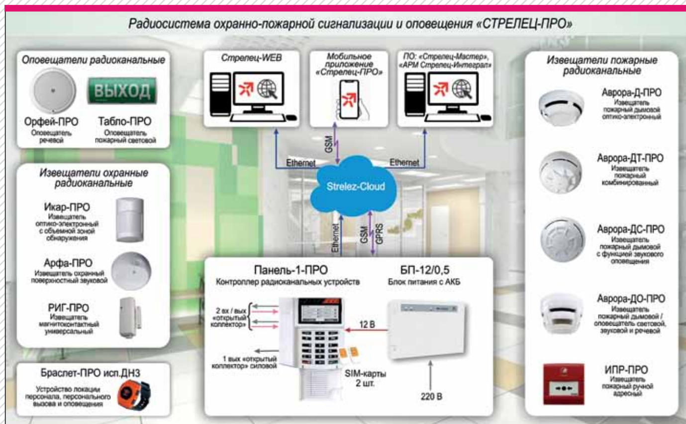
Рис. 1. Схема построения радиоканальной системы ОПС и оповещения
